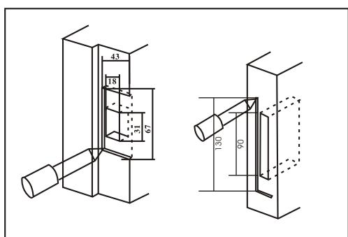
2. 在門和門框上根據已畫好的線，用合適的工具打孔、鑿槽。
