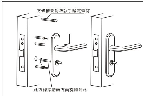
特別注意：A安裝方條時要將槽口對準執手緊定螺釘一邊。B鎖體必須處于未保險狀態，斜舌能自由伸縮。C外覆板安裝時先拔出鑰匙，再將鎖頭上小方條按鎖舌伸出方向反向旋轉至止，才能將小方條插入鎖體小方孔中，否則會出現鑰匙拔不出或鎖不了門的現象。
