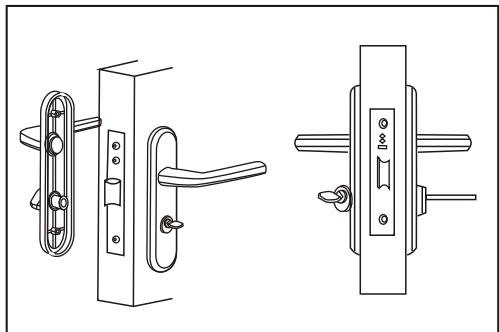
6.按圖安裝鎖扣盒、鎖扣板,用2個木螺釘固定。
