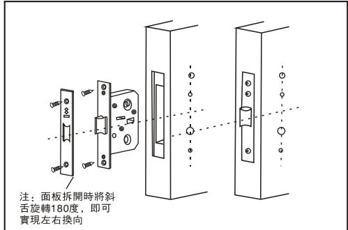
5.將內覆板的執手旋鈕套入鈕能否保險，執手能否帶動斜舌伸縮靈活，然後用兩個覆板螺釘將其緊固，再用緊定螺釘將執手緊固。
